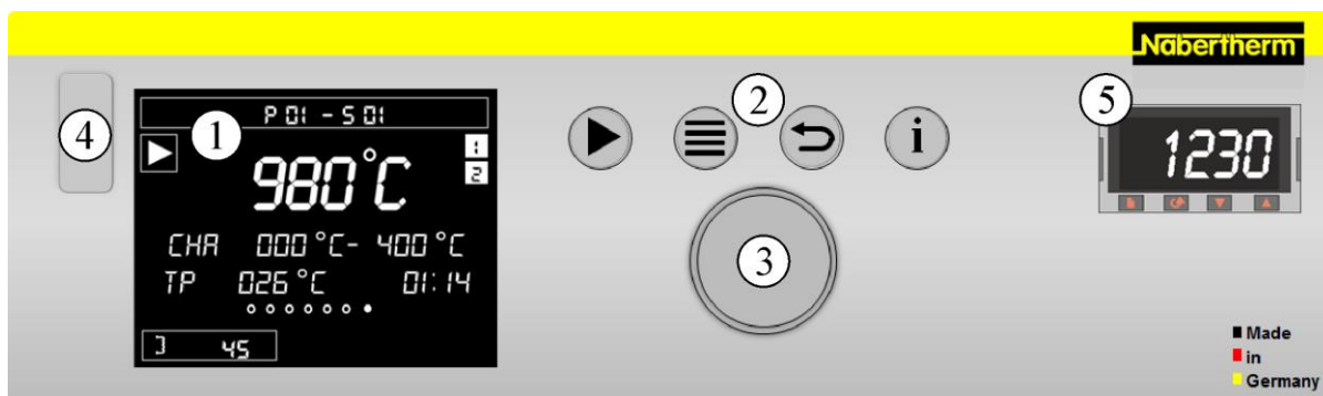
Rys. 2: Panel sterowania B410/C450/P480 (wygląd zbliżony)
