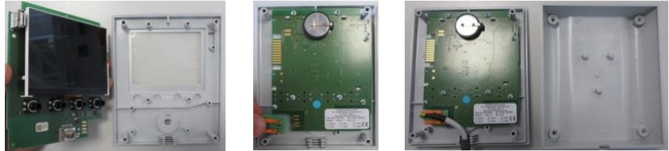
Rys. 15: Montaż płytki kontrolera – część 2 (wygląd zbliżony)
