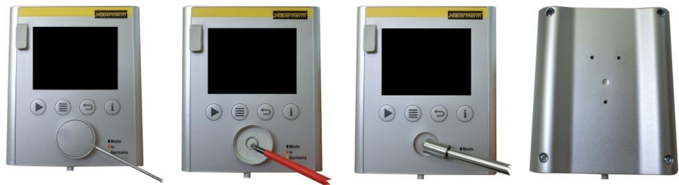
Rys. 12: Demontaż płytki kontrolera – część 1 (wygląd zbliżony)
