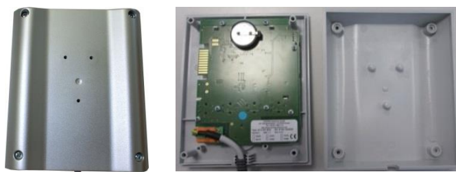
Rys. 11: Wymiana kontrolera (wygląd zbliżony)
