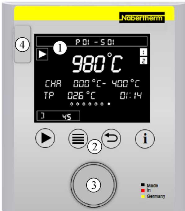
Rys. 3: Panel sterowania B400/C440/P470 (wygląd zbliżony)
