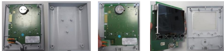
Rys. 13: Demontaż płytki kontrolera – część 2 (wygląd zbliżony)
