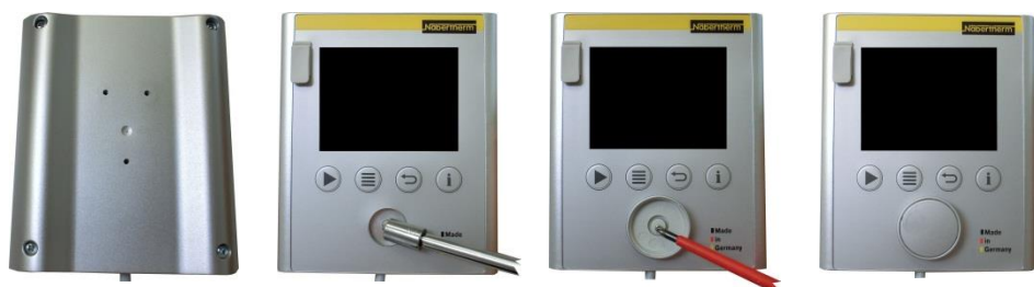
Fig. 16: Montering af controllerens printkort – del 3 (eksempelbillede)
