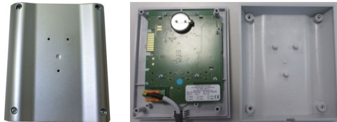
Sl. 11: zamjena upravljačkog uređaja (slično kao na slici)
