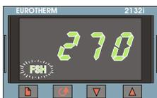
Il selettore-limitatore di temperatura Eurotherm 2132i monitora la temperatura nel vano forno attraverso un circuito di misura indipendente. Se la temperatura del vano forno aumenta oltre il valore impostato (generalmente  $T_{max} + 30\text{ °C}/86\text{ °F}$ ), il riscaldamento viene disinserito per mezzo di un contattore di sicurezza per proteggere il forno – sul selettore-limitatore di temperatura lampeggia l'allarme "FSH".
