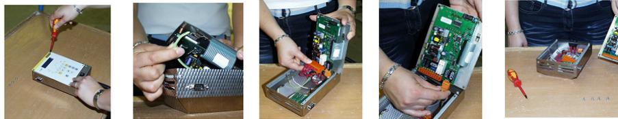
Fig. 28: Sostituzione di un controller
