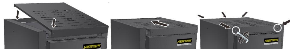
Bild 52: Montering av skyddsplåt på modell LHT 03/17 D (liknar den på bilden)
