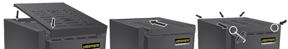
Bild 40: Montering av skyddsplåt på modell LHT 03/17 D (liknar den på bilden)
