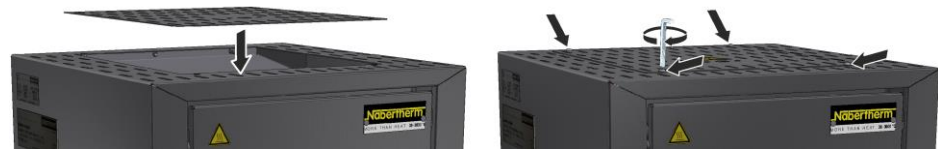
Bild 39: Montering av skyddsplåt på modell LHT 01/17 D (liknar den på bilden)
