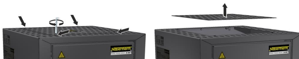
Bild 44: Demontering av skyddsplåt på modell LHT 01/17 D (liknar den på bilden)
