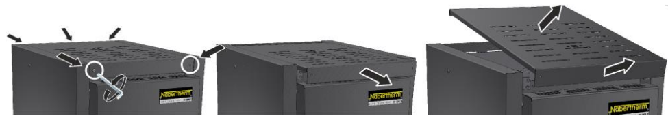
Bild 45: Demontering av skyddsplåt på modell LHT 03/17 D (liknar den på bilden)
