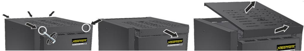
Bild 56: Demontering av skyddsplåt på modell LHT 03/17 D (liknar den på bilden)
