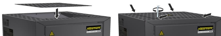
Bild 19: Montering av skyddsplåt på modell LHT 01/17 D (liknar den på bilden)
