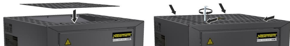
Bild 51: Montering av skyddsplåt på modell LHT 01/17 D (liknar den på bilden)
