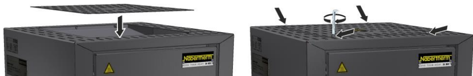
Fig. 39: Montering af afdækningen model LHT 01/17 D (eksempelbillede)
