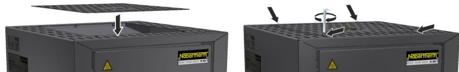
Fig. 51: Montering af afdækningen model LHT 01/17 D (eksempelbillede)
