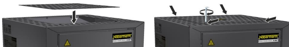
Fig. 19: Montering af afdækningen model LHT 01/17 D (eksempelbillede)
