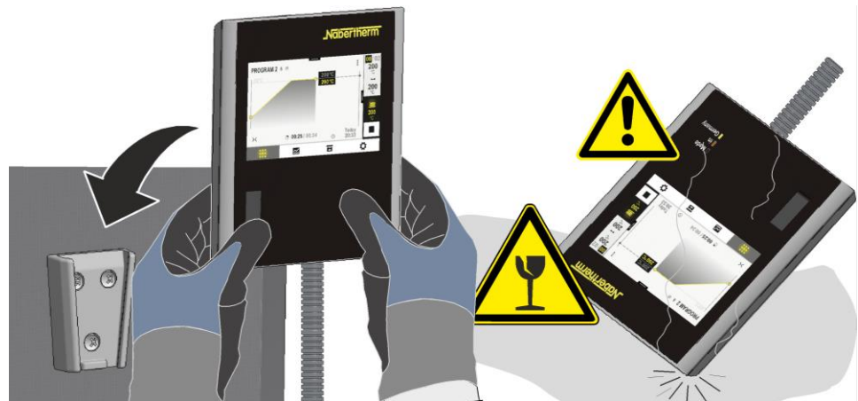
Bild 71: Isättning av kontrollern i den hållare som finns på ugnen (liknar den på bilden)
