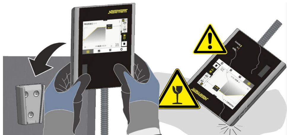
55 pav.: įstatyti reguliatorių į krosnyje esantį laikiklį (panašu į paveikslėlio vaizdą)
