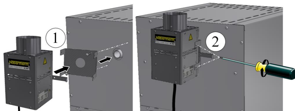
Slika 22: Dimna cev z ventilatorjem (podoben kot na sliki)
