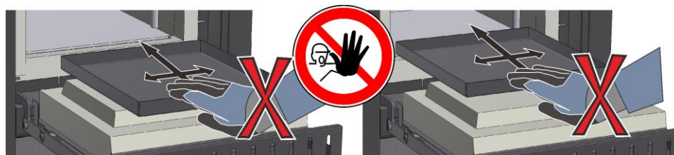
Slika 36: Primer: Preprečitev poškodb izolacije vrat (podobno kot na sliki)
