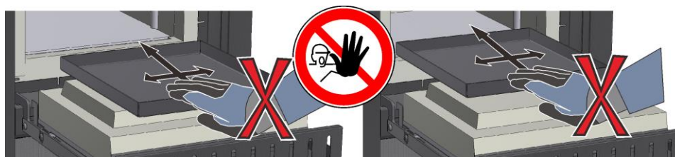
36. ábra: Példa: Az ajtószigetelés sérülésének elkerülése (az ábrához hasonlóan)
