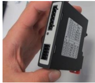
10. ábra: Szabályozómodulok kiszérése – 2. rész (az ábrán láthatóhoz hasonlóan)
