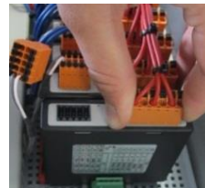
11. ábra: Szabályozómodulok beszerelése (az ábrán láthatóhoz hasonlóan)
