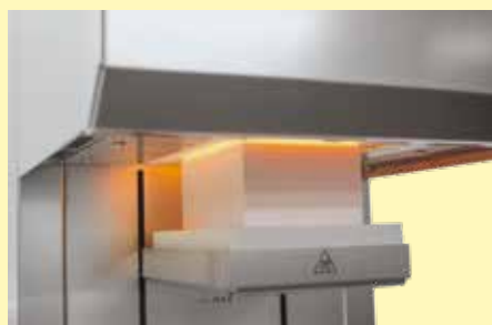
Sole elevatrice avec motorisation électrique
