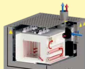
Representación esquematizada de la guía de aire en el horno combinado LHT 08/17 BO
