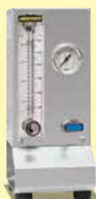
Sistema de gasificación para gases no inflamables
