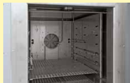
Interior con bandeja de inserción, termopares y control de la presión
