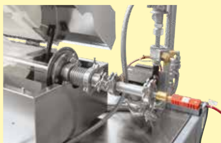
Versión rotativa estanca al gas con refrigerador de gas y termopar de cargas
