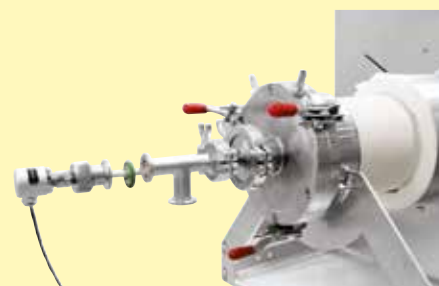
Termopar para la regulación de la carga
