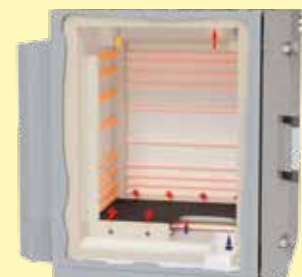
箱式炉N (B) .. B0内的气流示意图
