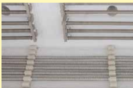
采用纤维隔热层, 用于缩短加热和冷却时间
