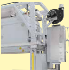
催化后燃烧装置集成在窑炉外壳上，以节省空间
