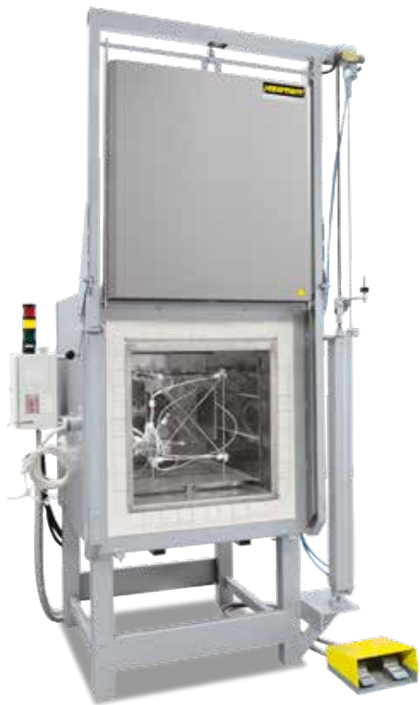
用来测量温度均匀性的测量架
