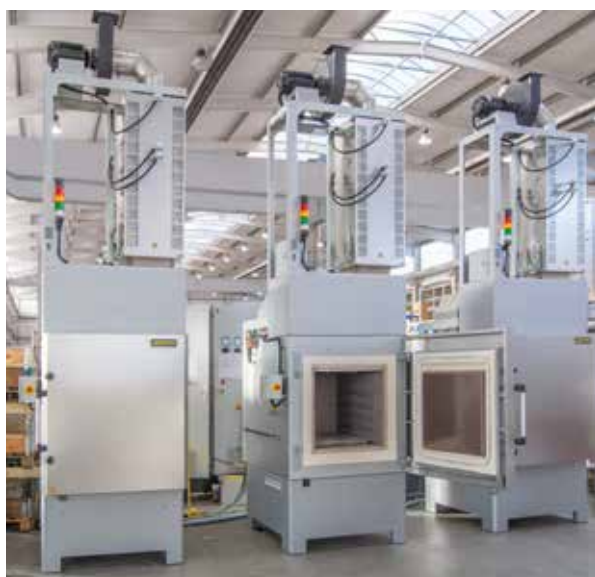
生产设备配备3台空气循环箱式炉NA 250/85 DB200用于排胶和催化后燃烧装置KNV 320（采用节省安放空间的设计）
