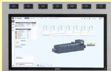
通过NCC显示所有可设置值（例如：加热区的温度监测、气体流量）
