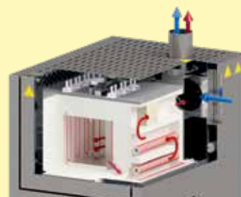
组合炉LHT 08/17 B0空气导入示意图
