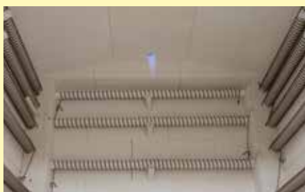
N 300 B0炉膛采用燃气点火火焰和电容炉加热装置
