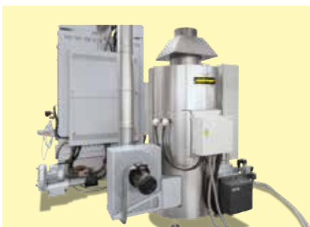
催化或热力后燃烧装置可选配（图片显示的是热力后燃烧装置）
