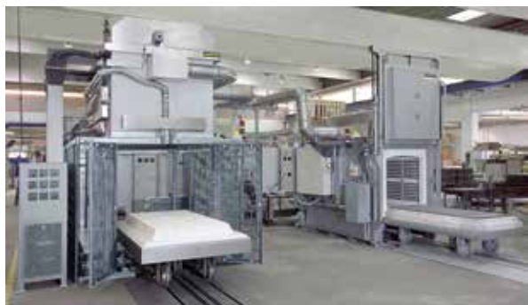
高温罩式炉HT 1700/17 LT DB200-5用于陶瓷粉末的排胶和烧结
