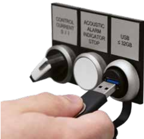
NTLog Comfort通过U盘记录西门子PLC的数据
