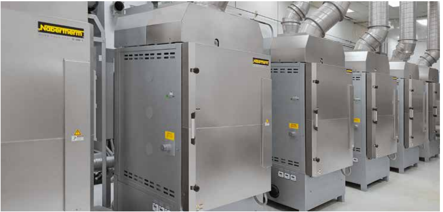
生产线包括组合箱式炉N 650 DB200配备催化后燃烧装置用于交替运行
