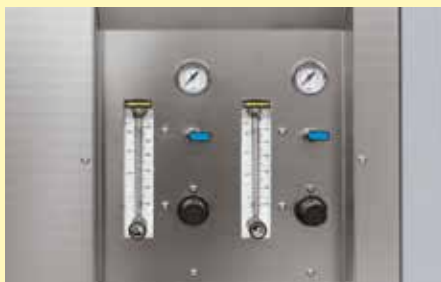
自动供气系统带电磁阀和转子流量计
