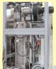
用于净化废气的催化后燃烧装置，作为额外配置
