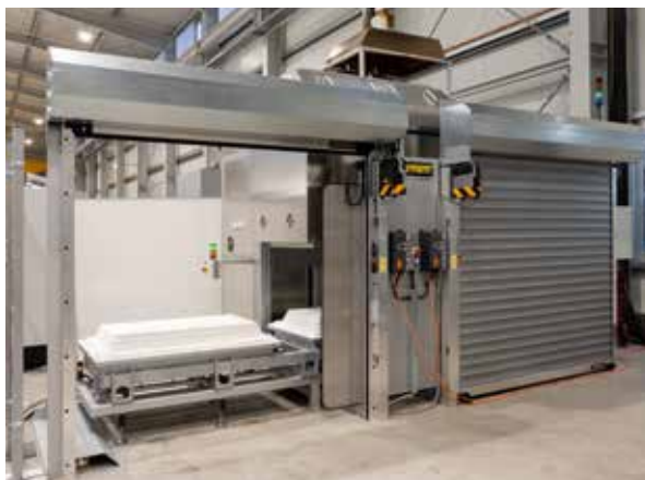
高温罩式炉HT 400/17 LT DB200-4配备滚轮门用于自动更换工作台
