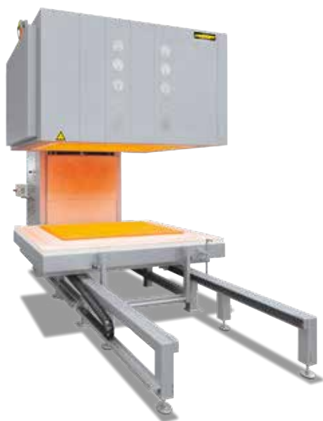
底部升降炉H 1600/S用于石英玻璃的热处理。窑炉采用适合在1000℃下打开的设计。工作台可拉出，用于处理工件。
