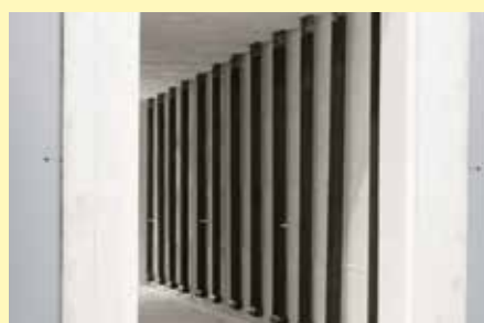
SiC加热元件位于台车炉的两侧
