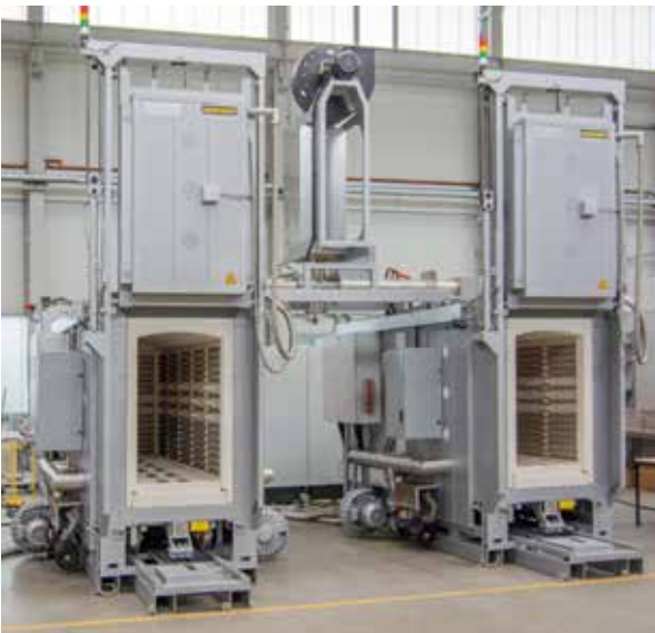
两台组合式台车炉W 2254/14 DB200-4配备用于交替运行的催化后燃烧系统
