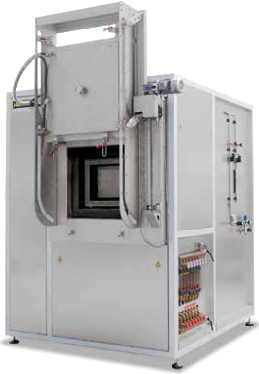
Horno de retorta VHT 40/22-GR con puerta guillotina motorizada y marco frontal para la conexión a una cabina de seguridad con guantes
