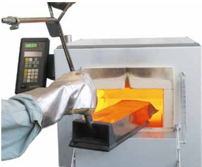
Proceso de temple con bolsa de recocado
