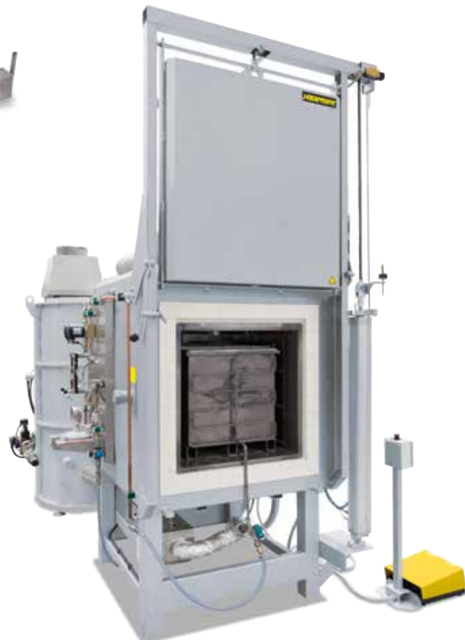
Horno de circulación de aire N 250/65 HA IDB con caja de protección de gas para la desaglomeración inerte en atmósfera de gases protectores incluyendo postcombustión térmica (TNV). Ver también el catálogo Materiales Avanzados.
