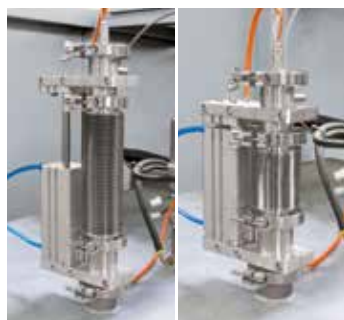
Termoelementos tipo S con dispositivo de retirada automático, para garantizar buenos resultados de medición en el rango de temperatura más bajo
