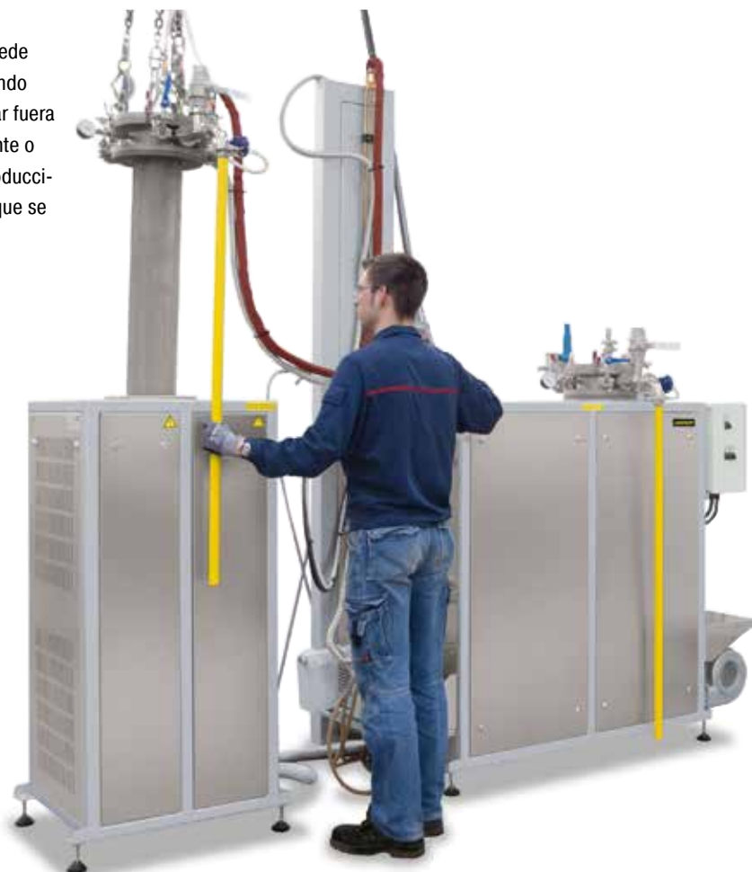
Horno de retorta SR 170/1000/11 con retorta intercambiable y estación de enfriamiento
