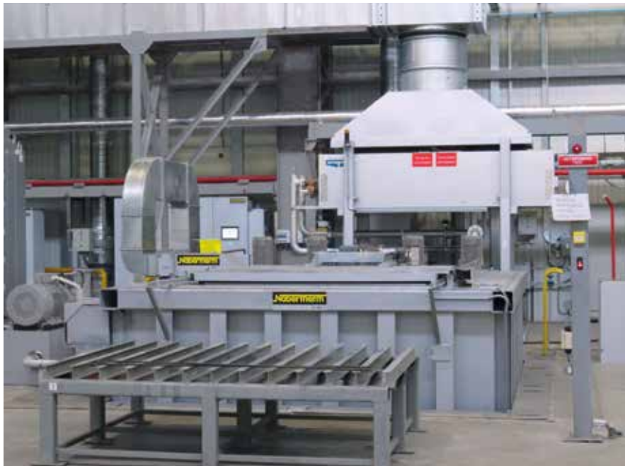
Baño de enfriamiento de aceite OAB 67000 con intercambiador de calor con una capacidad de 67.000 litros de aceite
