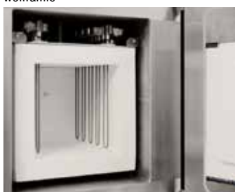
Elemento calefactor de molibdeno disiliciuro y aislamiento de fibras
