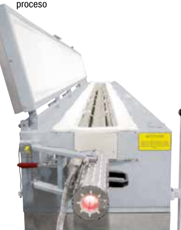
Horno para recocer alambres continuos en base a un honor tubular con una longitud de 6 metros
