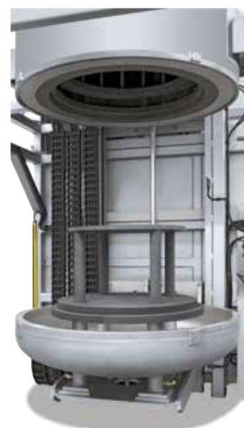
Horno de retorta LBVHT con suplemento calefactor de grafito
