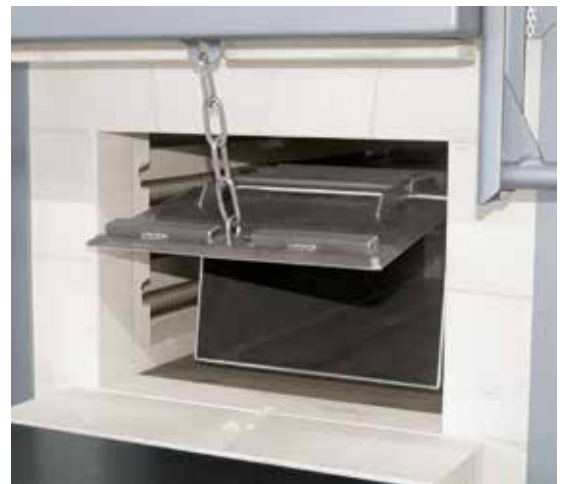
Caja de recocado con tapa que se abre junto con la puerta del horno
