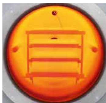
NR 50/11 con carro de carga para la extracción manual a altas temperaturas para el enfriamiento en un baño externo
