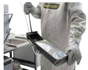
Utilización de bolsas de recocido para la inyección de gas
