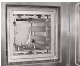
Elemento calefactor de molibdeno o wolframio
