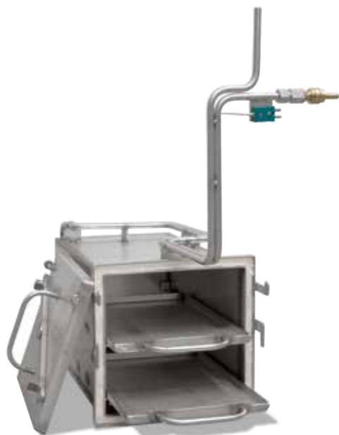
Caja de gasificación con módulos extensibles
