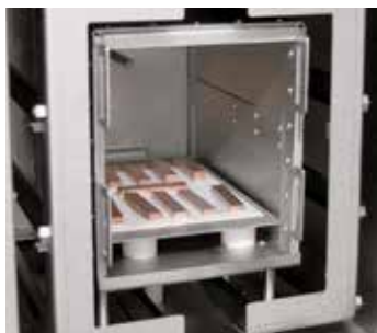
Tratamiento térmico de varillas de cobre bajo hidrógeno en horno de retorta VHT 8/16-MO
