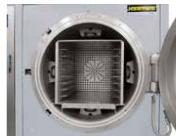
Retorta con calentamiento interior
