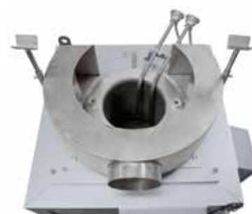
TS 30/18 con dos termopares de baño salino para el tratamiento térmico de aluminio
