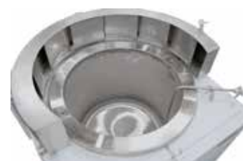
Pec se solnou lázní TS 90/80 s jedním termočlánkem v solné lázni pro tepelné zpracování oceli
