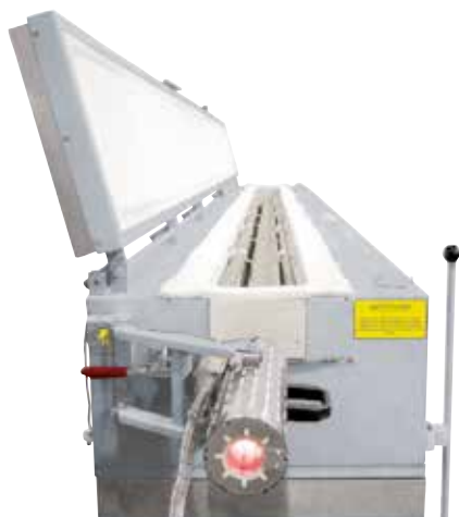
Průběžná pec na dráty, založená na trubkové peci dlouhé 6 metrů
