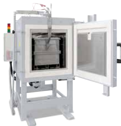
Oběhová komorová pec N 250/85 HA se zaplynovací komorou pro tepelné zpracování v ochranné atmosféře
