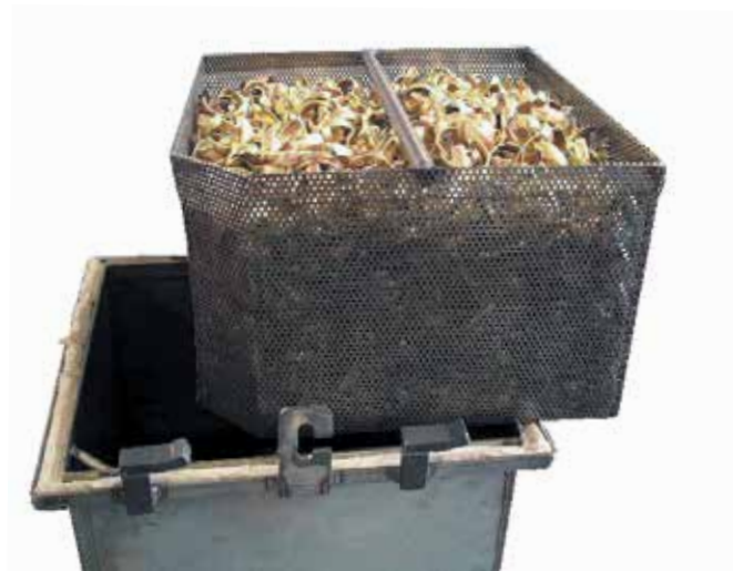
Lesklé žihání sypkého materiálu v zaplynovací nádobě s možností odstranění vakua
