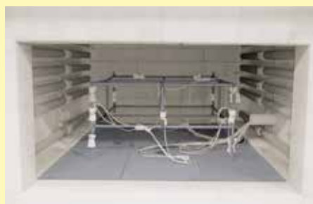
Měřicí konstrukce v žihací peci
