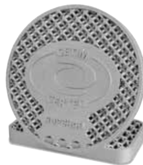
Tištěná součást z hliníku, tepelně zpracovaná v modelu N 250/85 HA (výrobce CETIM CERTEC na platformě SUPCHAD)
