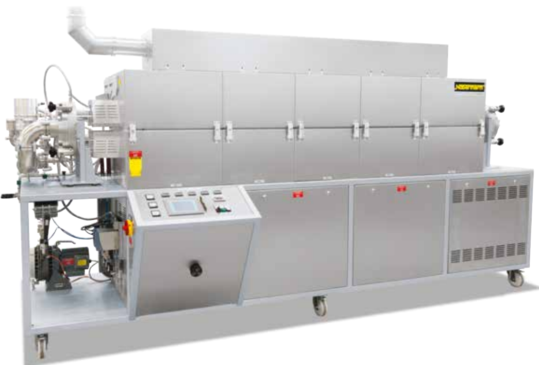
RS 250/2500/11S, pětizónová, pro žhání ve vysokém vakuu a ochranné atmosféře, včetně rychlého chlazení a komínu na odpadní vzduch
