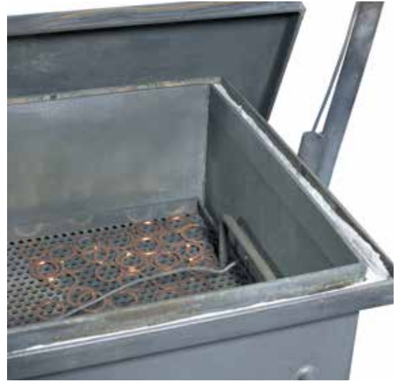
Tepelné zpracování v zaplynovací nádobě v ochranné atmosféře s termočlánkem pro vsázku
