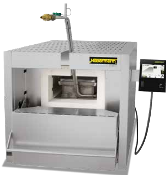
Žihací pec N 7/H, jako stolní model s volitelnou zaplynovací nádobou
