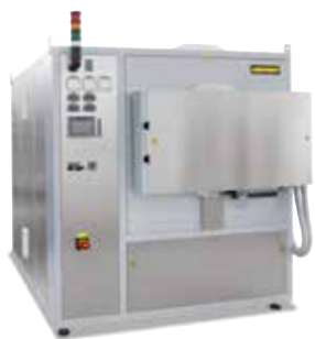
Retortová pec NR 150/11 pro žhání kovových součástí pro snížení pnutí po 3D tisku
