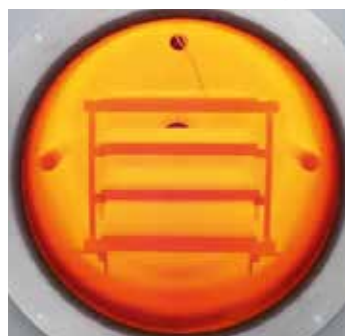
NR 50/11 s vsázkovým stojanem pro ruční odběr při vysokých teplotách pro ochlazení v externí lázni
