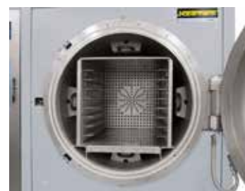
Retorta s vnitřním vytápěním
