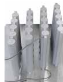
Tažené pruty z titanu po tepelném zpracování v peci NR 50/11 v argonové atmosféře
