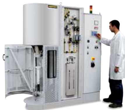
Trubková pec RHTV 120/480/16 SBS s jednostranně uzavřenou pracovní trubicou, možností inertního plynu a podtlaku a také s elektrickým vřetenovým pohonem zvedacího stolu
