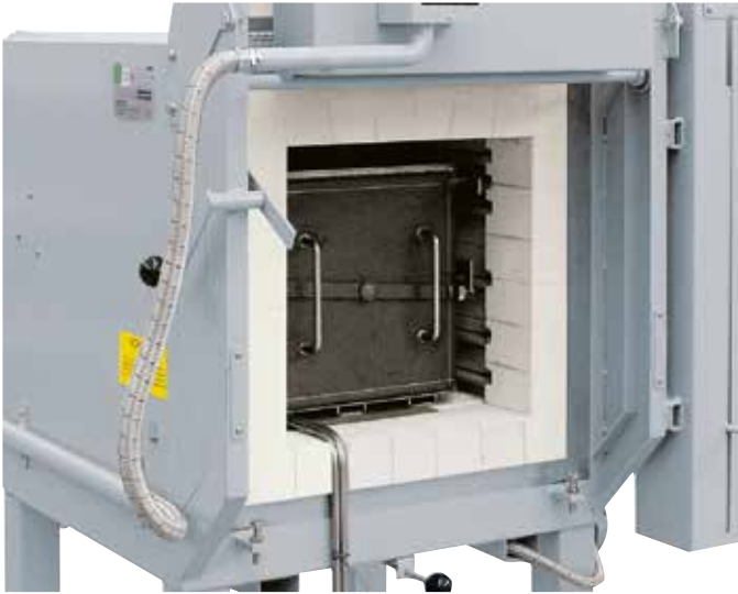
Pevně zabudovaná zaplynovací nádoba s vkládáním vsázek zředu
