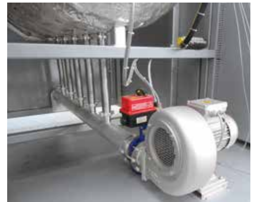
Chlazení ventilátorem u retortových pecí (horká stěna retorty) NRA 400/03
