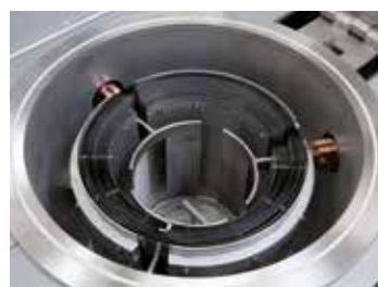
Válcová retorta s wolframovým ohřevem
