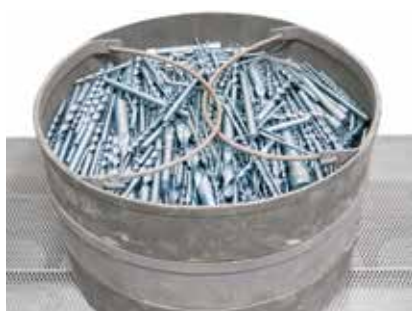
Modření vrtáků vodní párou v peci řady NRA viz strana 16
