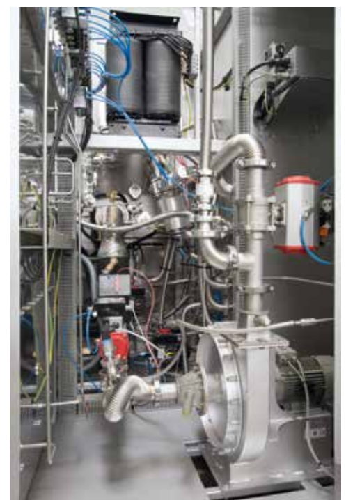
Rychlé chlazení plynu u retortových pecí (studená stěna retorty) VHT 8/16-MO
