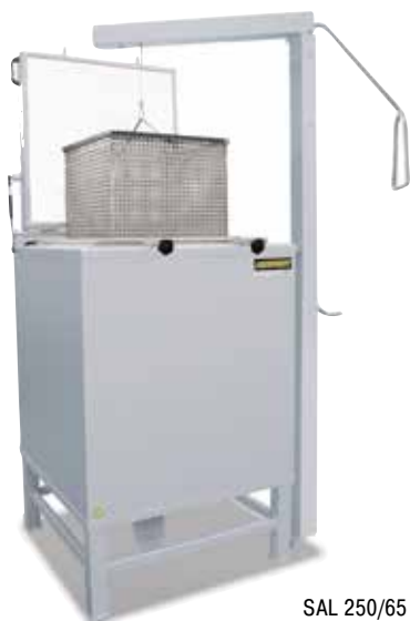
Šachtová pec SAL 120/65 s bednami s ochranným plynem a chladicí stanicí vedle pece
