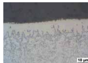
Detailní snímek metalografického brusku oceli pro práci za tepla bórované v prášku
