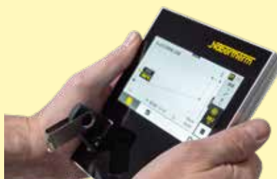
Zaznamenávání procesních dat připojeného kontroléru pomocí USB flash disku
