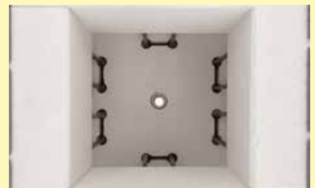
Très bonne uniformité de température grâce au chauffage général de la chambre du four
