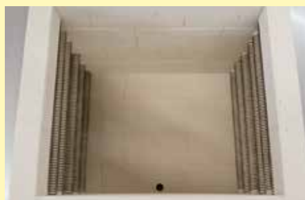
Los elementos calefactores en los tubos soporte aseguran una libre difusión del calor
